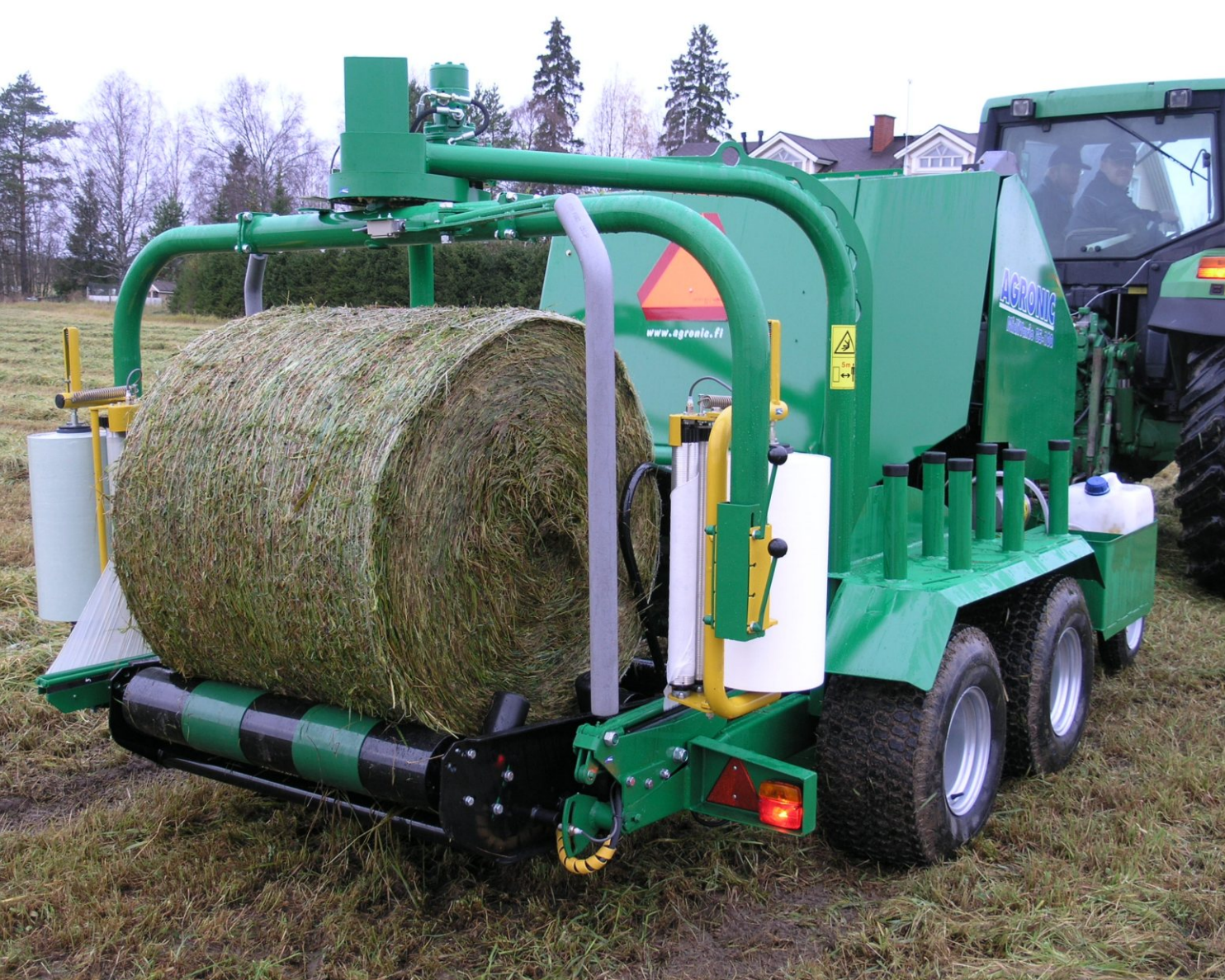
Valot ja muovirullatelineet vakiona, koneessa kulkee mukana 8 kpl muovirullaa. Hapottinlaitteet lisävarusteena.
