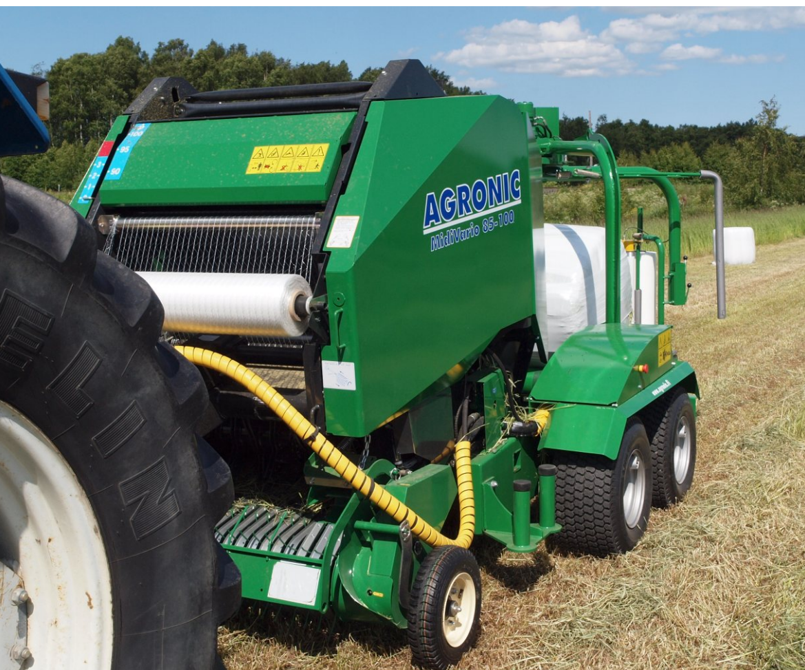
Valot ja muovirullatelineet vakiona, koneessa kulkee mukana 8 kpl muovirullaa. Hapottinlaitteet lisävarusteena.
