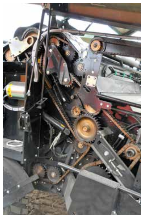
↑ Voimansiirto on jäykkä, paalikammion päävoimansiirtoketju on kaksirivinen.
