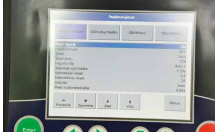
↑ Paalainohjelmista valitaan käytettävä esivalintaohjelma ja pystytään tekemään halutut säädöt, kieli luonnollisesti suomi.
