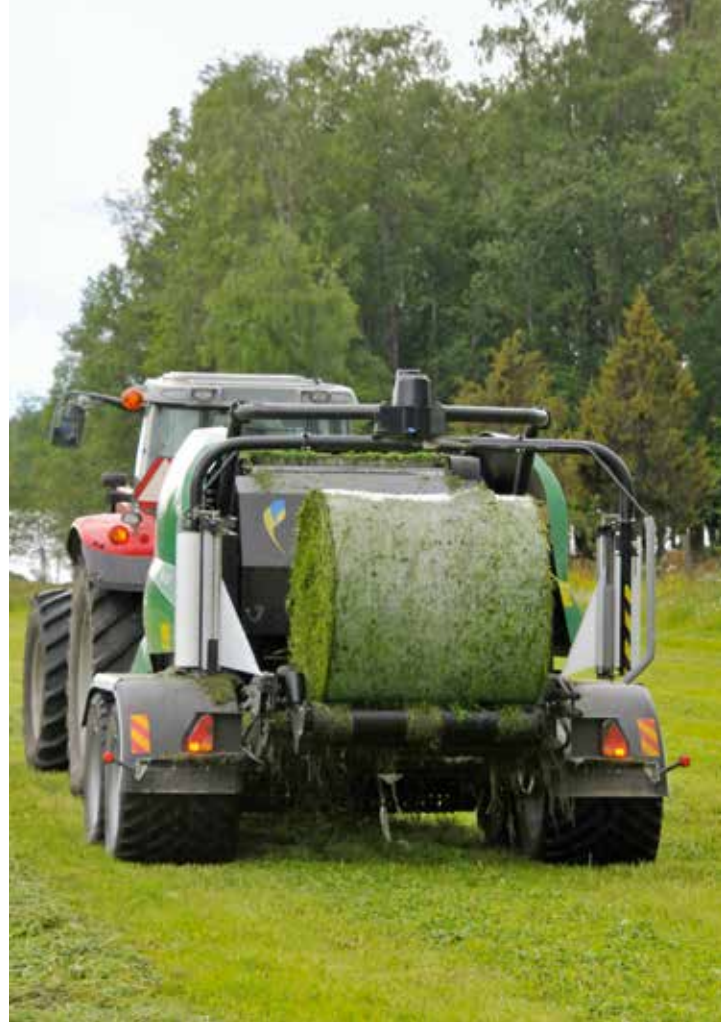
↑ Agronicissa on vakiona muovi- ja verkkosidonta, sidontatapa valitaan käyttölaitteesta. Molemmat sidontatavat toimivat moitteetta kokeilun aikana.
