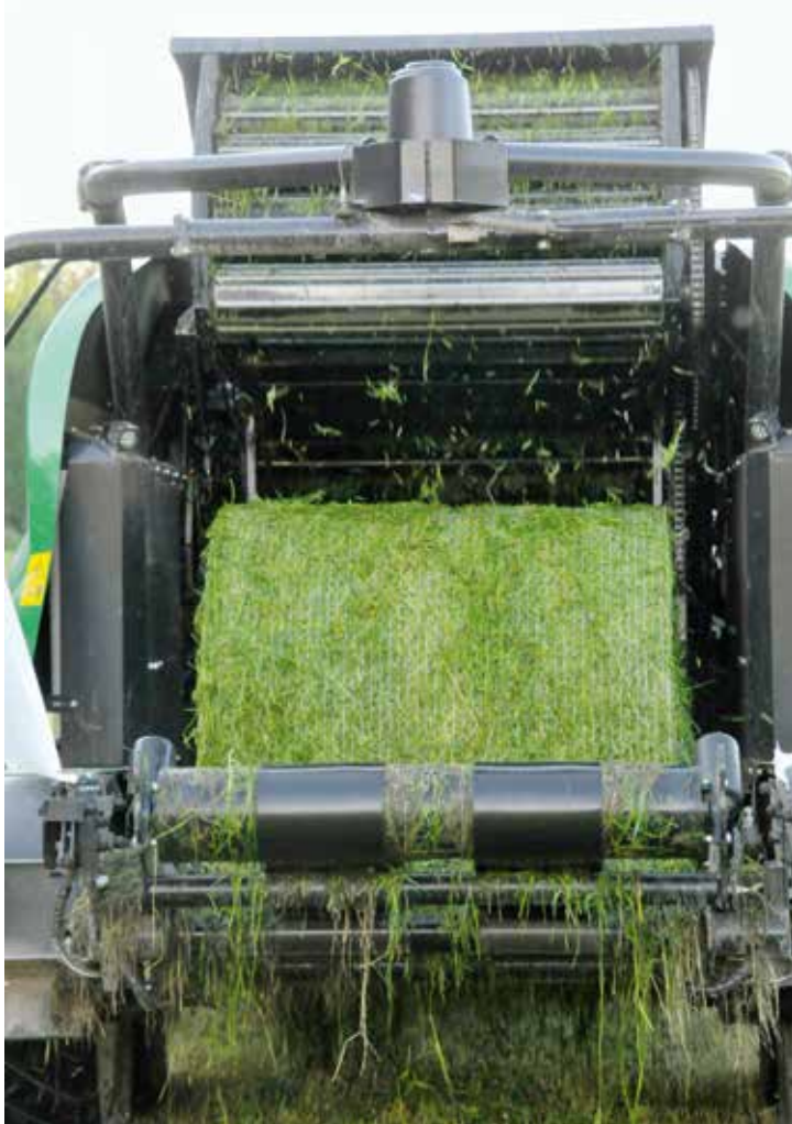
↑ Agronicissa on vakiona muovi- ja verkkosidonta, sidontatapa valitaan käyttölaitteesta. Molemmat sidontatavat toimivat moitteetta kokeilun aikana.
