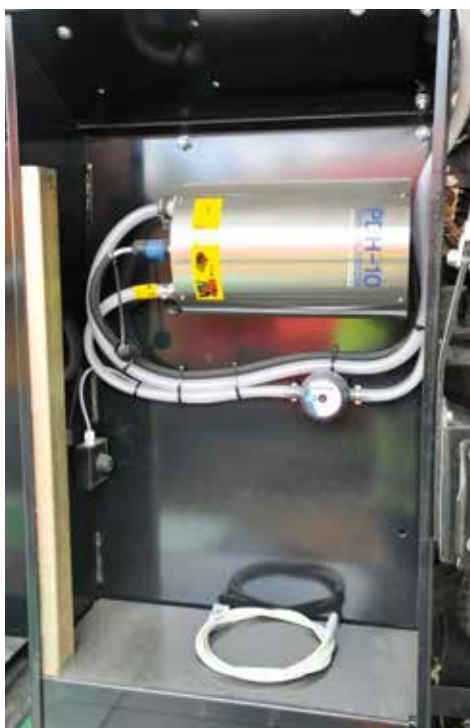
↑ Kuvassa näkyy automaattinen säilöntäineannostelija, jota ohjataan paalaimen ohjelmalla.
