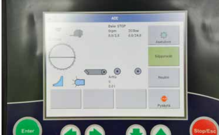
↑ Paalauksen aikana perusnäyttö on tämän näköinen. Asetuspainikkeen alla on esimerkiksi paalin tiukkuuden säätö.
