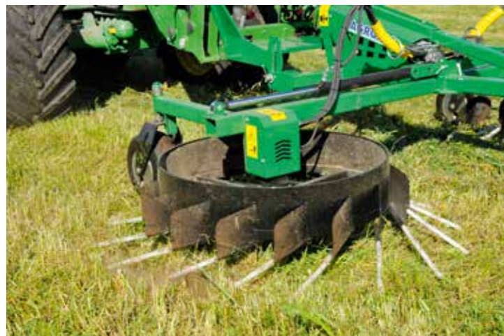
↑ Karhottimen piikit on tehty nylonmuovitangosta, jotka ovat loivassa kulmassa roottorin kehään nähden. Jättökulma on suuri, mikä vähentää maahan uppoamisen vaaraa ja epäpuhtauksien päätymistä rehuun.
