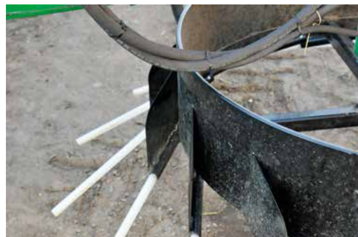
↑ Roottorin kehällä on piikkien lisäksi siivet, jotka tehostavat materiaalin siirtymistä.
