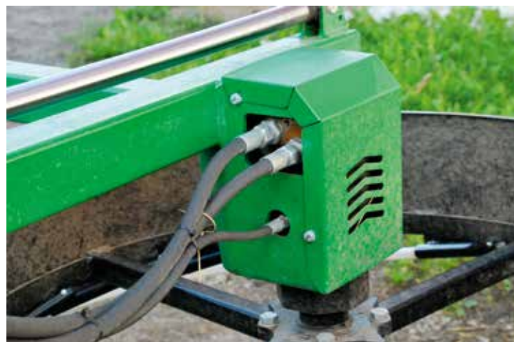
↑ Kumpaakin roottoria pyöritetään omalla hydraulimoottorilla.
