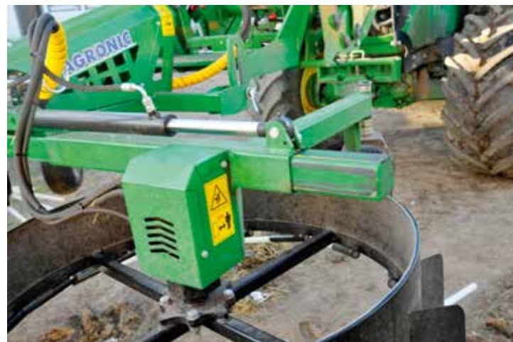
↑ Työlevyettä säädetään hydraulisesti siirtämällä roottoreita liukuholkissa.
