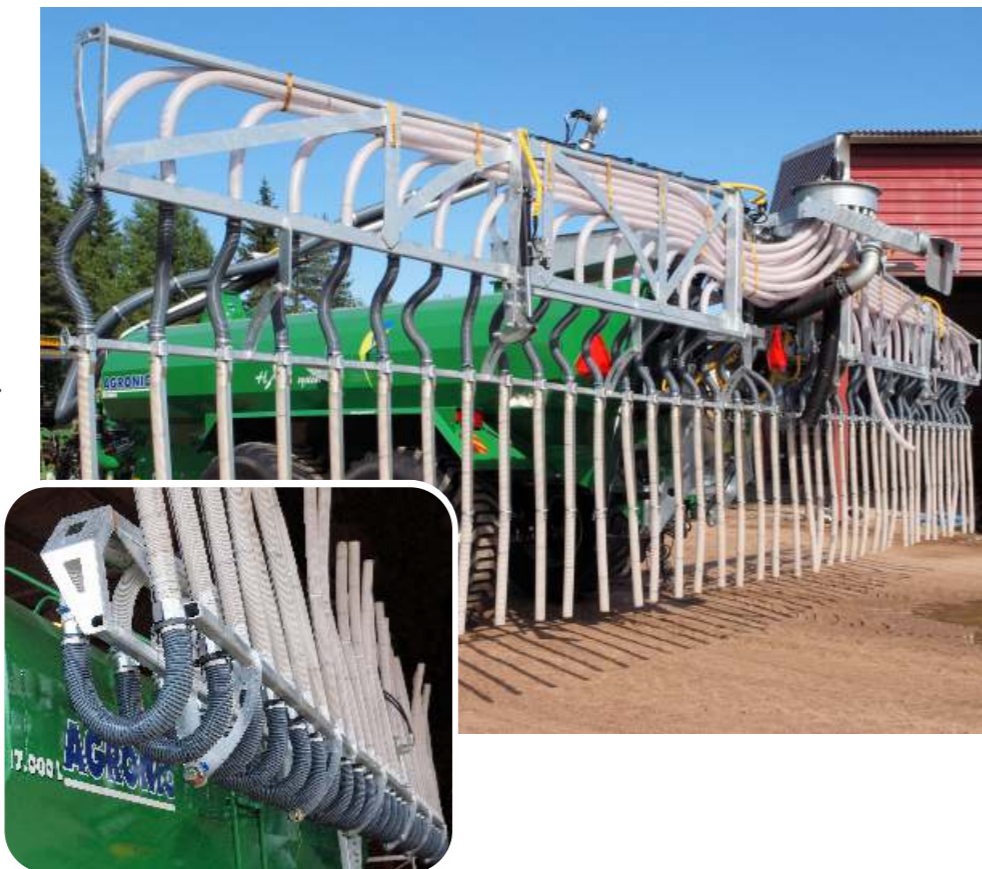
Kuljetusasento on kompakti, siipien taitto on automatisoitu.
