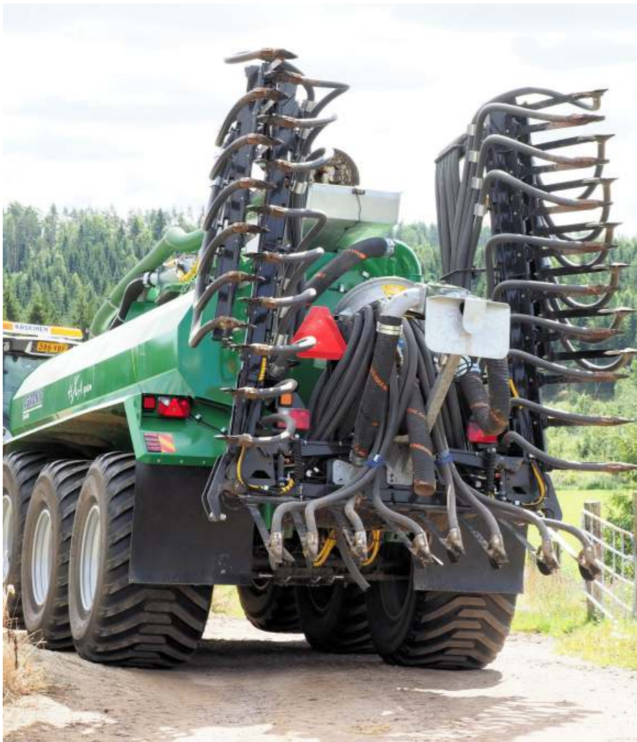
Kuljetusasento on kompakti, siipien taitto on automatisoitu.
