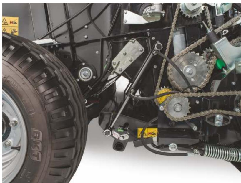
Une transmission robuste distribue la puissance des deux côtés de la presse à balles.
