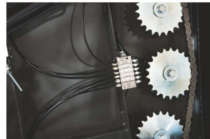
Lubrification automatique de la chaîne en standard.
