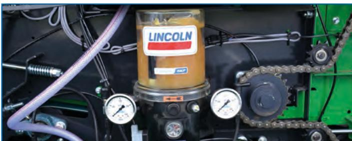
Автоматическая система смазки Lincoln. Простая и эффективная система смазки всех подшипников и вращающихся деталей машины. Система полностью автоматизирована и имеет резервуар объемом 4 л.
