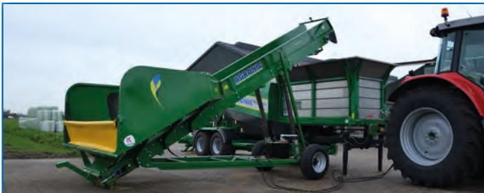
Когда требуется высокая загрузочная способность. Объем загрузки: 2,5-3 тонн. Ширина загрузочной ленты: 1,20 м. Непосредственная выгрузка сырья из грузовика в приемный бункер.
