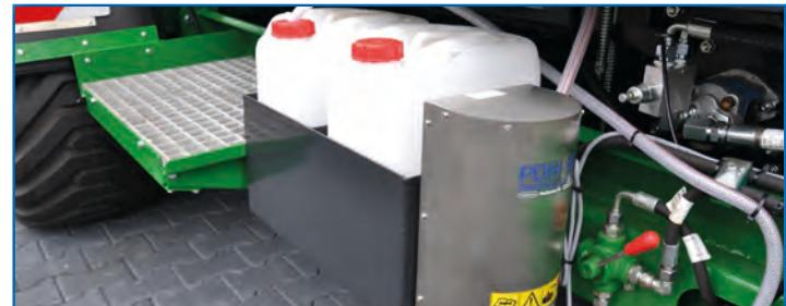
Полностью автоматизированная система подачи консервантов в процессе обмотки. Емкость насоса 10 л/мин. Подача контролируется блоком управления AGRONIC.
