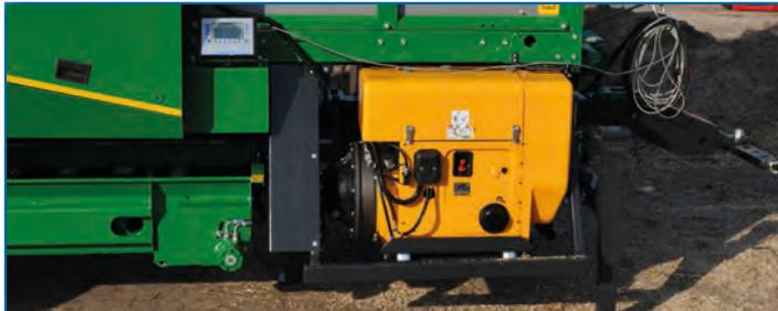
Экономная эксплуатация посредством подсоединенного напрямую дизельного двигателя с низким расходом топлива. На пресс-обмотчик устанавливается малошумный двигатель, что упрощает как стационарное, так и мобильное использование машины.
