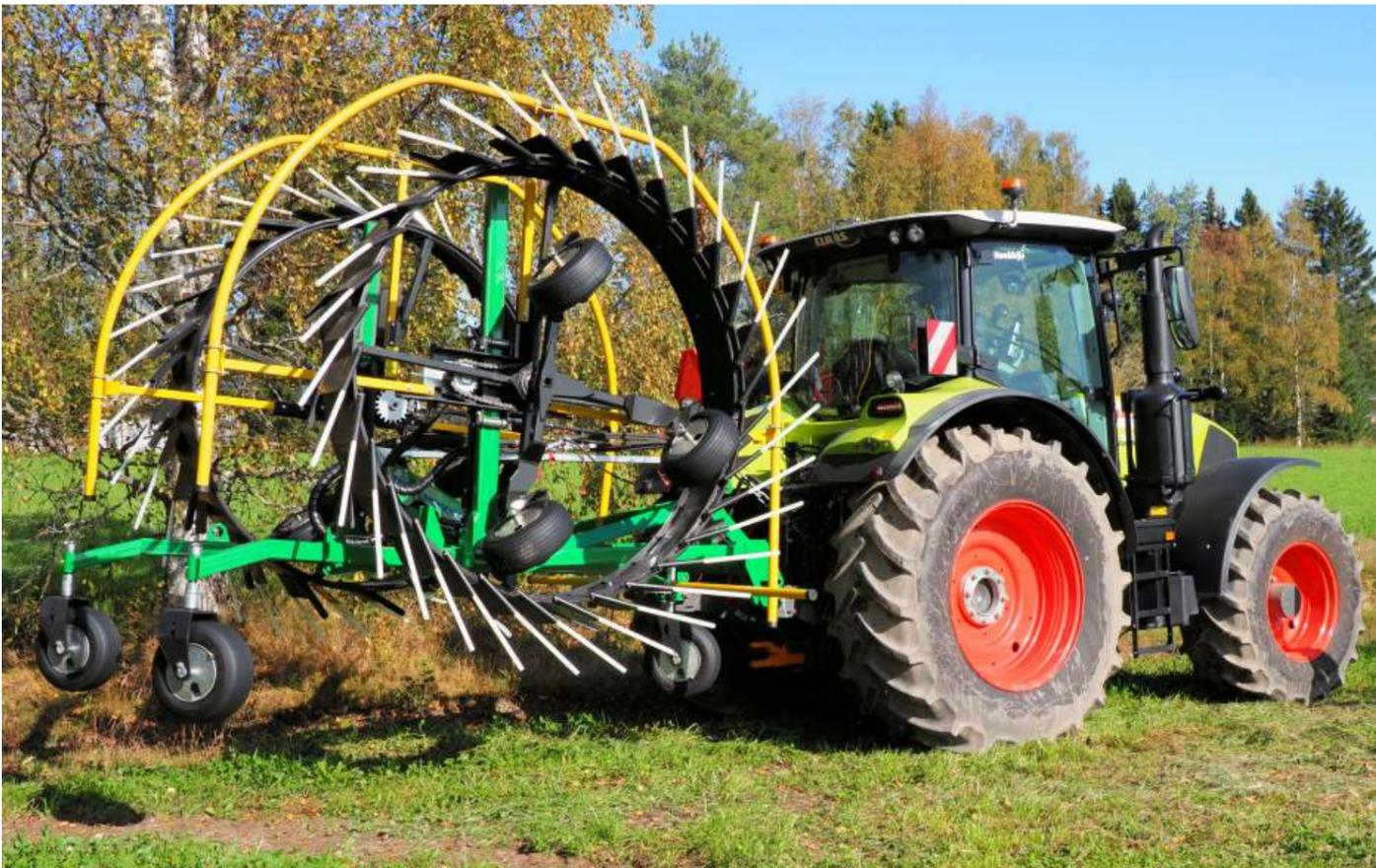
Contrairement aux autres modèles de la gamme d'andaineurs WR, le WR 700 dispose de 3 roues de support montées à l'intérieur des rotors. Grâce à la poutre flottante, les rotors peuvent suivre indépendamment les contours du champ. Les roues disposent également d'un réglage de la hauteur en continu facile à utiliser.
