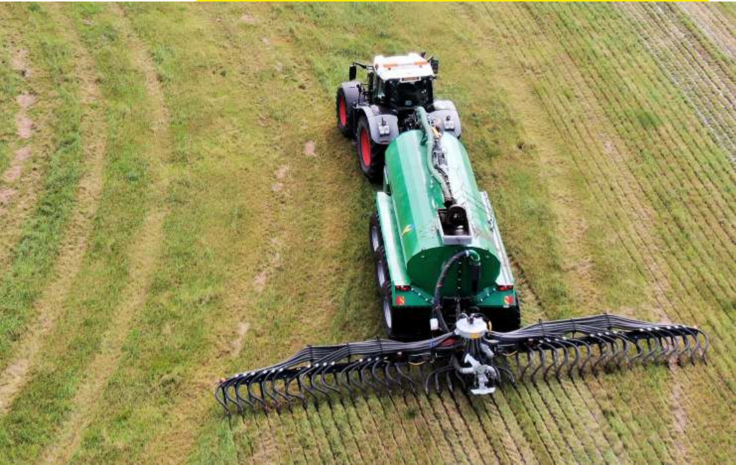
Каркас навески-культиватора наклоняется и поворачивается независимо от цистерны.
