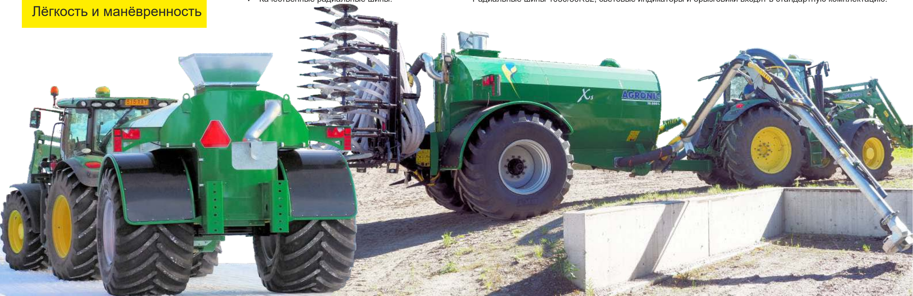
Радиальные шины 1050/50R32, световые индикаторы и брызговики входят в стандартную комплектацию.
