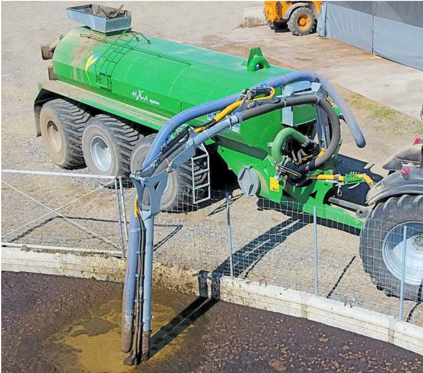
Стрела загрузки AGRONIC с центральным креплением поворачивается в обе стороны.
