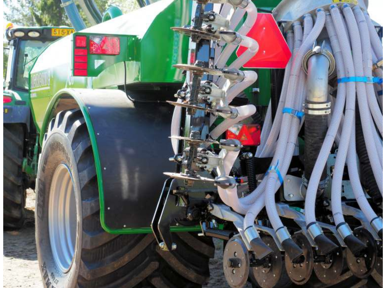
Радиальные шины 1050/50R32, световые индикаторы и брызговики входят в стандартную комплектацию.
