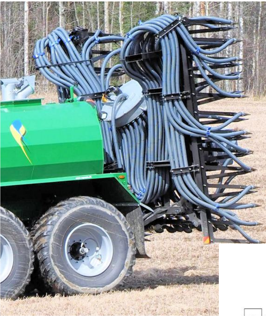
Kuljetusasento on kompakti, siipien taitto on automatisoitu.
