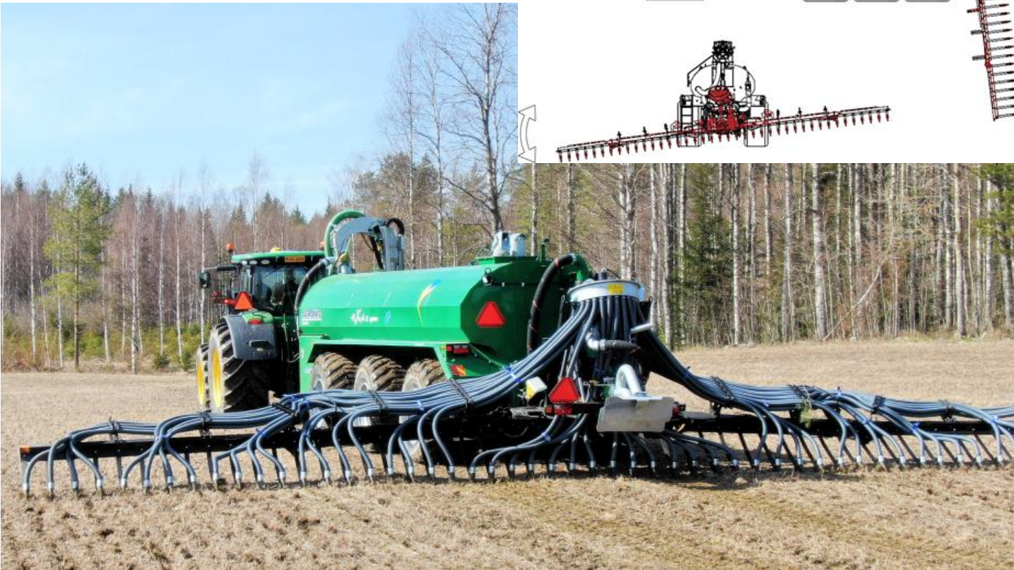
Kuljetusasento on kompakti, siipien taitto on automatisoitu.
