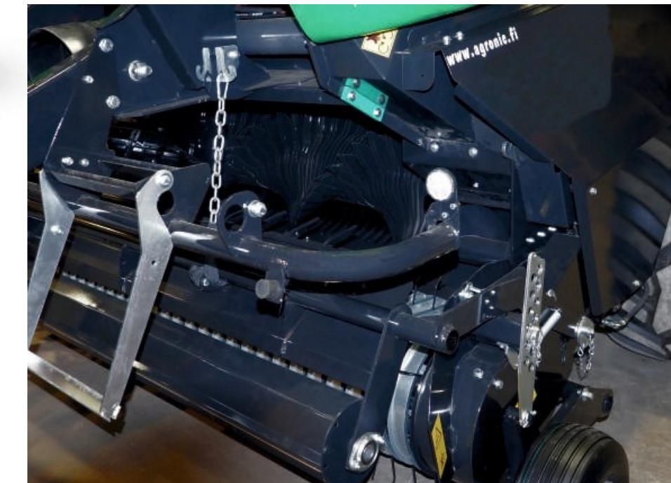
25 ножей и надежный ротор гарантируют равномерную подачу и быстрое измельчение материала при формировании тюков. Количество ножей может быть уменьшено гидравлическим способом.
