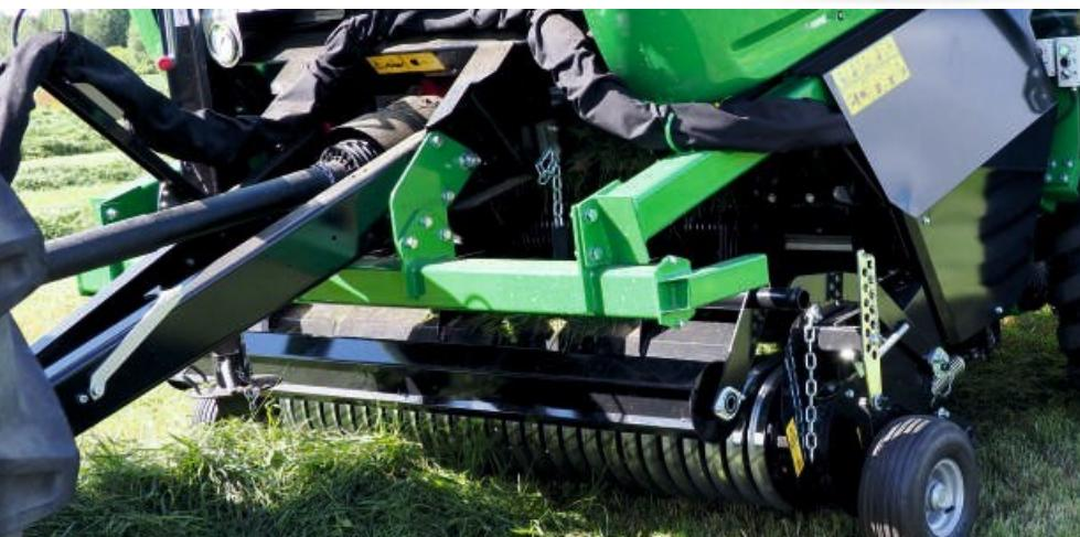
её на обе стороны машины. Слева — на вальцы, справа — на захват и подбирающий механизм. Автоматическая смазка цепей и централизованная система смазки входят в стандартную комплектацию.
