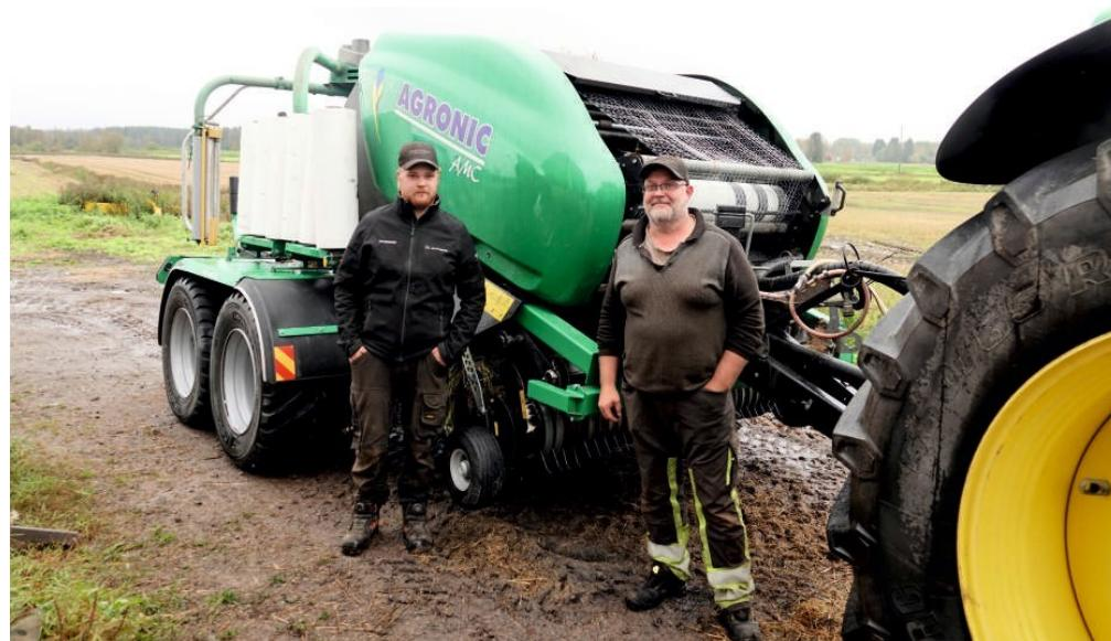
Шины Agronic с шириной профиля 710 миллиметров позволяют избежать чрезмерного уплотнения почвы. Шины пресс-подборщика, ширина которых превышает ширину колеи трактора, еще больше уменьшают образование борозд и ухабов. Автоматическая смазка цепей и центральная система смазки, которыми модель AMC оборудована в базовой комплектации, облегчают текущее обслуживание машины во время и без того хлопотного уборочного сезона.
