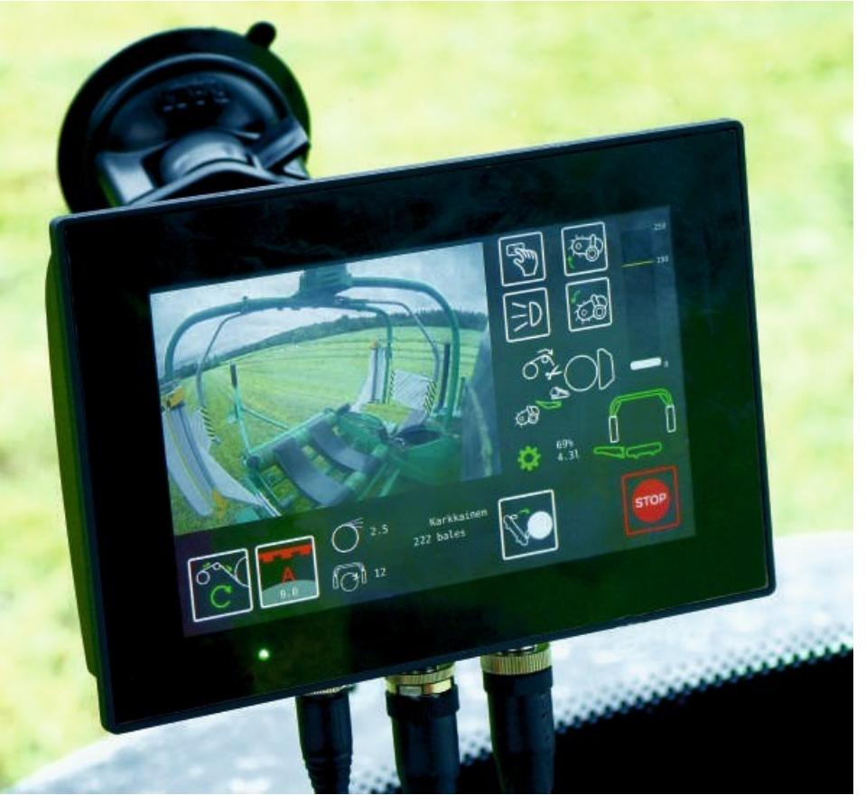
Удобный и простой в использовании **сенсорный экран** управления включает в себя управление работой пресс-подборщика и насоса для добавок, а также функцию памяти с большим количеством ячеек.
