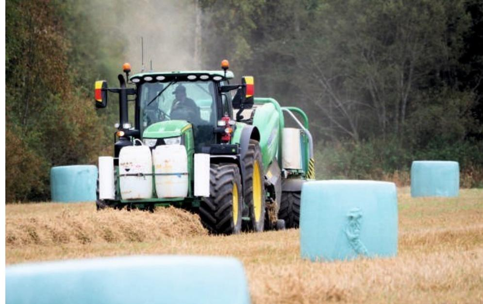
На панели управления с высококонтрастным цветным дисплеем в кабине трактора отображается вся информация и настройки, необходимые для управления машиной. **Встроенная система автоматически регулирует количество консерванта, подаваемого непосредственно в прессовальную камеру.**
