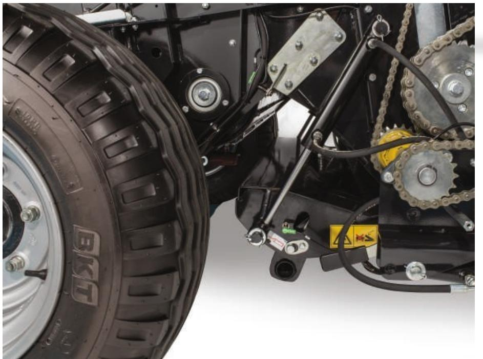
Чтобы устранить возможный засор, основание подбирающего механизма открывается электрогидравлическим способом. Подпружиненный захват плотно прижимается к земле. Автоматический выключатель захвата для защиты от перегрузки.
