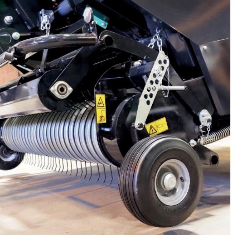
Мощный захват шириной 225 см разработан для эксплуатации в любых погодных условиях. 4 зубчатых лопасти и 120 двойных зубьев. Автоматический выключатель для защиты от перегрузки и прижимной ролик для подбора валков входят в базовую комплектацию.
