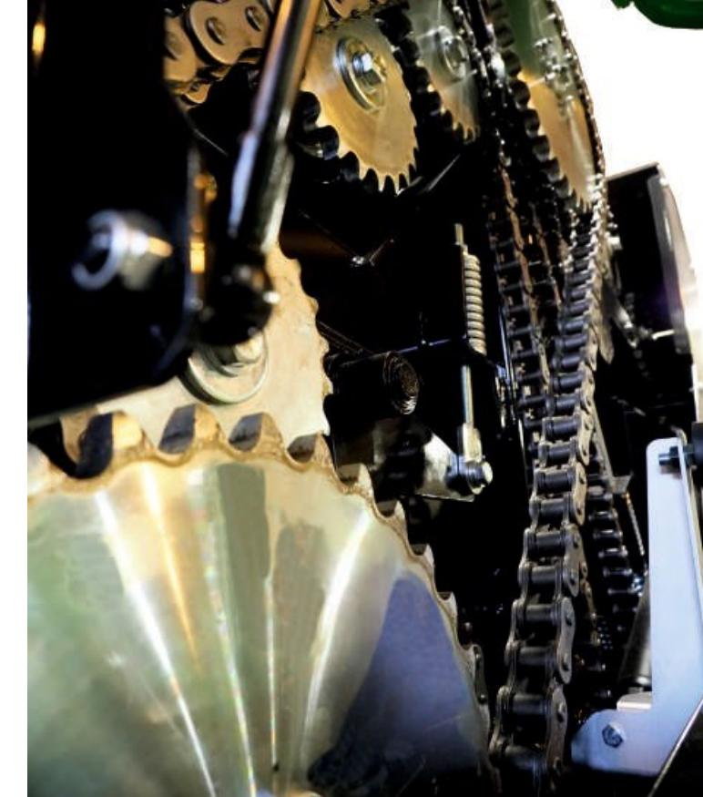
Автоматизация ножей позволяет укладывать кормоматериал с длинными стеблями по внешнему периметру тюка.
