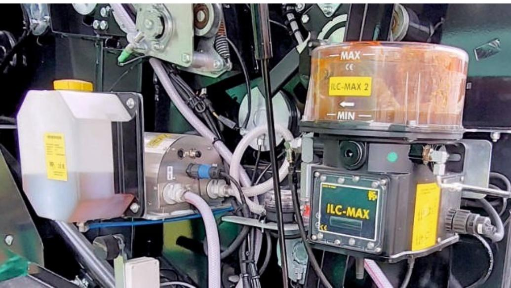
На фото емкость для смазки цепи, за ней — насосный агрегат системы введения добавок или консервантов, моющийся фильтр, а на переднем плане — насосный агрегат и емкость для централизованной смазки. Все это расположено с правой стороны пресс-подборщика в пределах легкой досягаемости и защищено от грязи.
