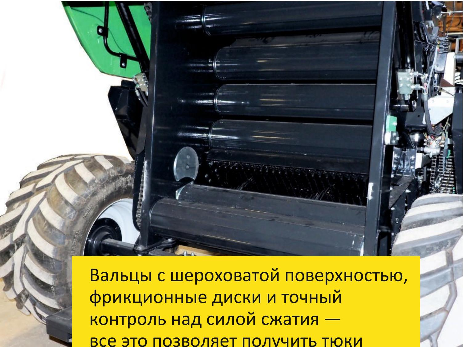
Вальцы с шероховатой поверхностью, фрикционные диски и точный контроль над силой сжатия — все это позволяет получить тюки неизменно высокого качества.
